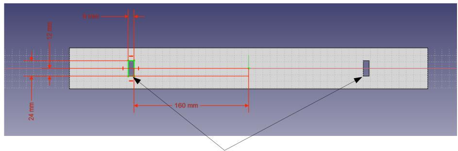
Emplacements pour capteur de contact
